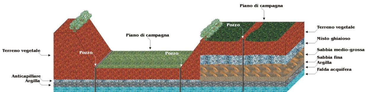
Fig. 11 Schema di ripristino per fini agricoli
